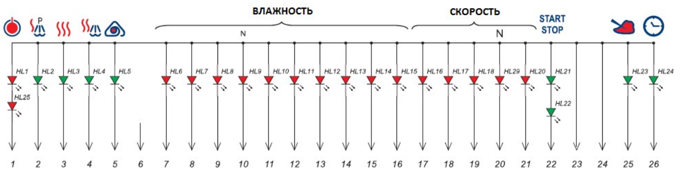
Схема электрическая соединения светодиодов
